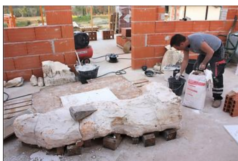
Fermeture du moule et remplissage de plâtre et filasse
